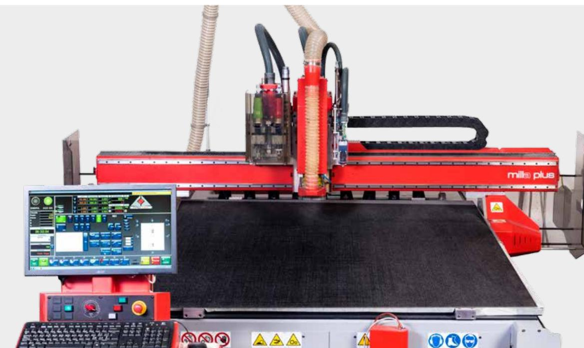
**Il nuovo centro di fresatura automatico per il fustellificio**
