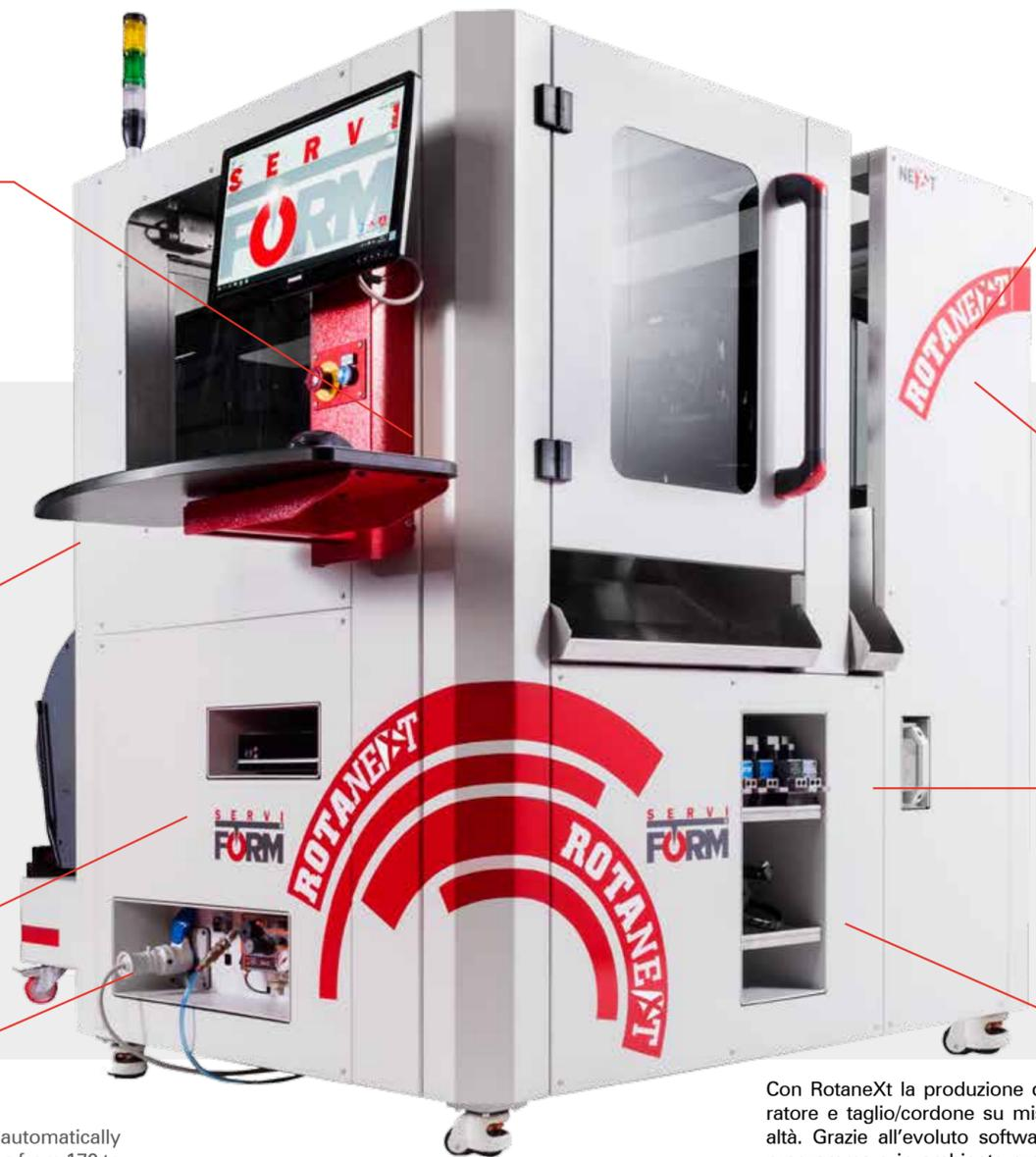
Tutte le operazioni di punzonatura vengono svolte da cartucce multiutensile di nuova generazione. Pilotate elettricamente e collegate ad un gruppo trancia elettrico, queste cartucce permettono di svolgere operazioni multiple (per esempio taglio, nasellatura, ponticellatura, marcatura delle pieghe, perforazione e taglio cordone).
